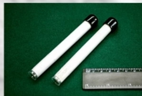
Диоксид циркония для плазменного нанесения покрытий стабилизированный 1.оксидом иттрия и 2.оксидом кальция
